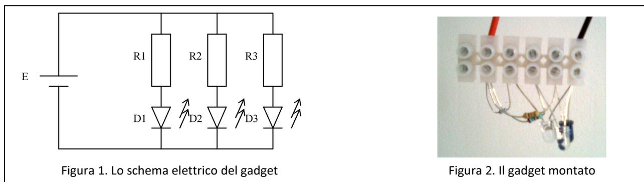
Figura 1. Lo schema elettrico del gadget
