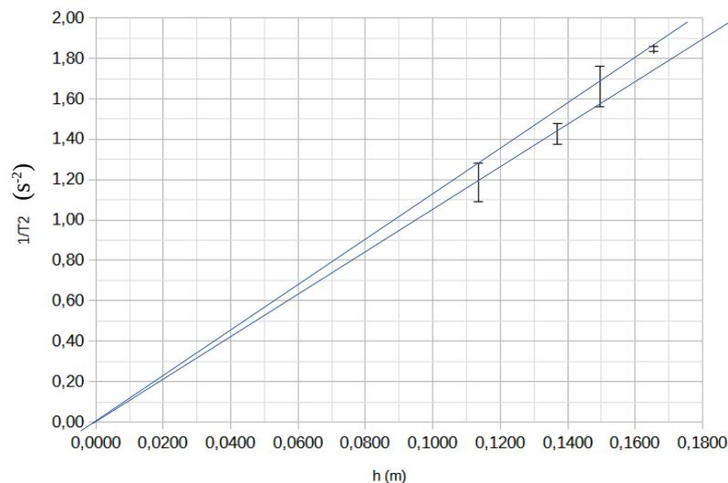
In tal modo si sono stimate  $m_{max} = 11,25 \text{ m}^{-1} \text{ s}^{-2}$  e  $m_{min} = 10,42 \text{ m}^{-1} \text{ s}^{-2}$ .
