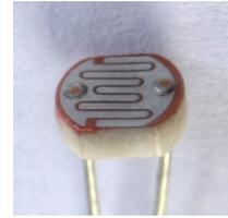
La relazione fra intensità luminosa sulla superficie e resistenza del componente non è lineare ma, entro certi limiti che dipendono dal tipo di componente usato, si può approssimare efficacemente con una proporzionalità indiretta come si vede nella figura seguente dove la resistenza  $R$  del LDR risulta proporzionale a  $1/R$  per un intervallo di intensità luminosa che va, approssimativamente, dai 1000 ai 4000 Lux.
