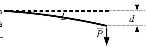
Riporta in un diagramma cartesiano i punti del grafico del peso applicato  $P$  (asse delle ordinate) in funzione della deformazione massima della stecca,  $d$  (asse delle ascisse).
