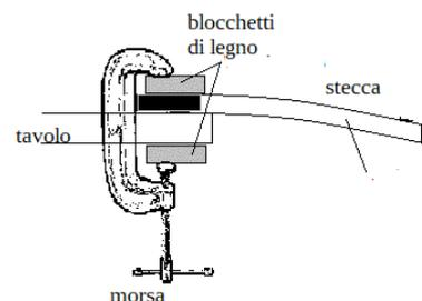
Disponi il bastone con il nastro millimetrato in maniera da poter individuare la posizione dell'estremità libera della stecca quando è priva di carico e in posizione orizzontale. Segna questa posizione: sarà il tuo riferimento a carico zero. D'ora in poi non dovrai spostare più il bastone con il nastro millimetrato.
