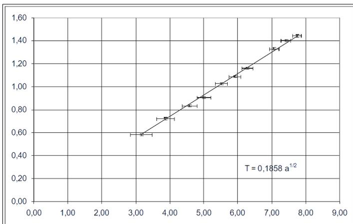
Figura 2: il grafico del periodo  $T$  in funzione della radice quadrata della lunghezza del lato  $a$  . Viene evidenziata la migliore retta approssimante una proporzionalità diretta. La retta tocca tutti gli intervalli di incertezza, la relazione è compatibile con le misure prese in questo esperimento.
