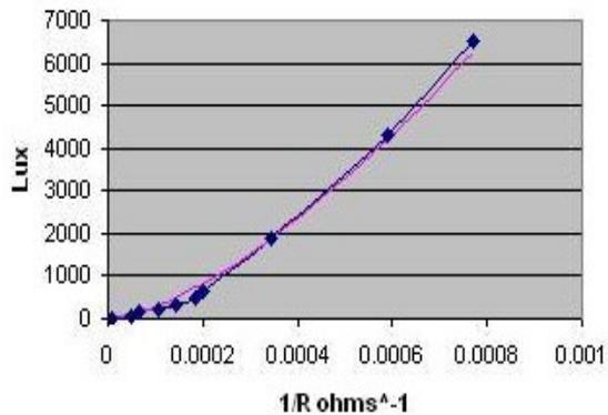
*intensità della luce su un LDR, misurata in Lux, in funzione del reciproco della resistenza del LDR. L'andamento della curva fra 1000 Lux e 4000 Lux è pressoché lineare.*
