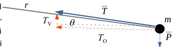
Ne segue che nella rotazione il cordino, lungo  $r$ , non può mantenersi orizzontale ma formerà con l'orizzontale un angolo  $\theta$ .
