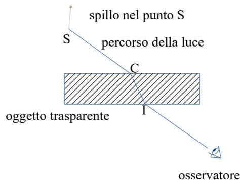
Un raggio di luce proveniente dallo spillo posto in S incide su un blocchetto trasparente in C, subisce la rifrazione, e vi esce in I con una nuova rifrazione. L'osservatore il cui occhio è colpito dal raggio vedrà i punti I, C ed S allineati lungo la retta che va dall'occhio a I e quindi lo spillo gli apparirà spostato a sinistra rispetto alla sua reale posizione.
