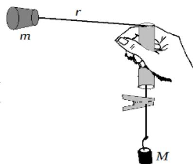
Poiché il dispositivo permette di controllare, mantenendole costanti, sia la lunghezza  $r$  che la massa dell'oggetto rotante  $m$ , potrai studiare la relazione fra la massa  $M$  che fornisce la tensione e la velocità raggiunta nella rotazione, e quindi il periodo della rotazione  $\tau$ . Alla fine sarai in grado di usare il dispositivo come una bizzarra bilancia e di ottenere con esso una misura della massa sconosciuta del sacchetto con la X che si trova sul tuo banco di lavoro.
