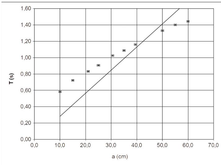
Figura1: il grafico del periodo  $T$  in funzione della lunghezza del lato  $a$  . Viene evidenziata la migliore retta approssimante una proporzionalità diretta. La relazione non è evidentemente compatibile con i dati.
