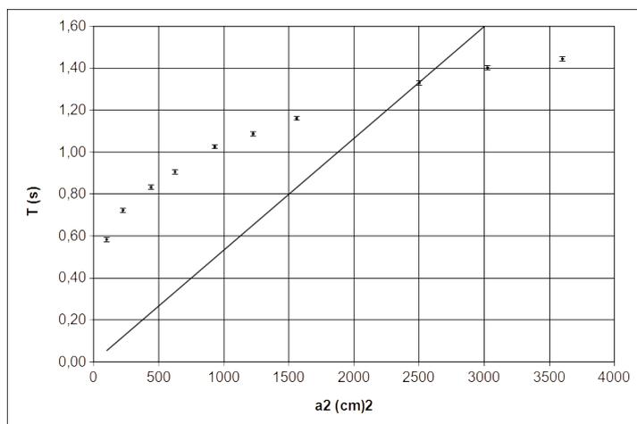
Figura 3: il grafico del periodo  $T$  in funzione del quadrato della lunghezza del lato  $a$  . Viene evidenziata la migliore retta approssimante una proporzionalità diretta. La retta non è compatibile con le misure prese in questo esperimento.
