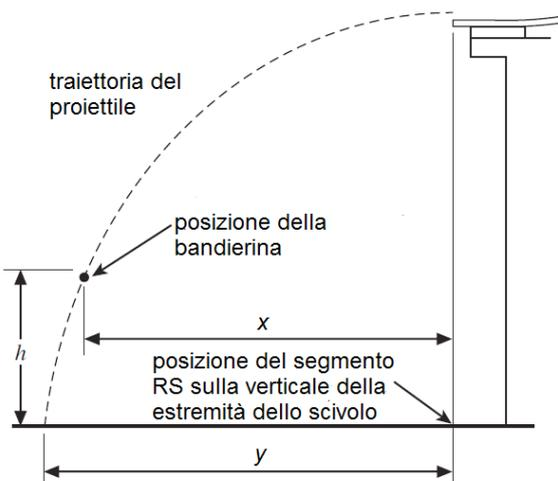
Allenta la morsa che tiene sollevato lo scivolo fissandolo all'asta di sostegno. Abbassa l'estremo sollevato dello scivolo di circa 5 cm. Controlla che in questa operazione lo scivolo non abbia subito torsioni e, se necessario correggi la sua posizione in maniera che non venga disturbato il moto della pallina quando scende.
