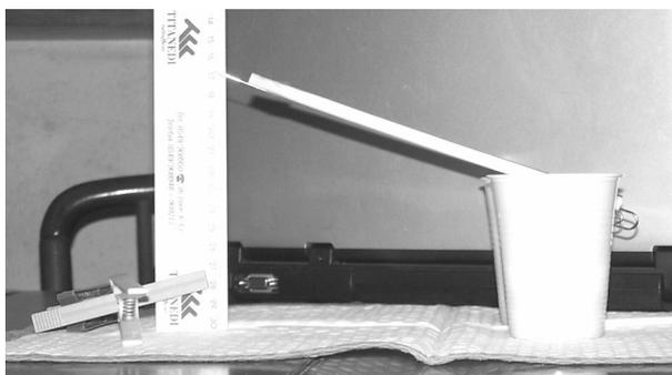
*Figura 1: Una possibile versione della bilancia. L'ago infisso trasversalmente nella cannuccia poggia sui bordi dei bicchieri appesantiti con dei piccoli dadi d'acciaio. Il righello è mantenuto in posizione verticale da un sistema di mollette da bucato.*
