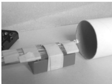
Il LED va mantenuto a distanza fissa dal fotoresistore. Lo abbiamo fissato su un righello piatto e abbiamo posizionato il righello entro al tubo a livello dell'asse centrale, fissando sotto al righello due blocchi rigidi di plastica per tenerlo sollevato.
