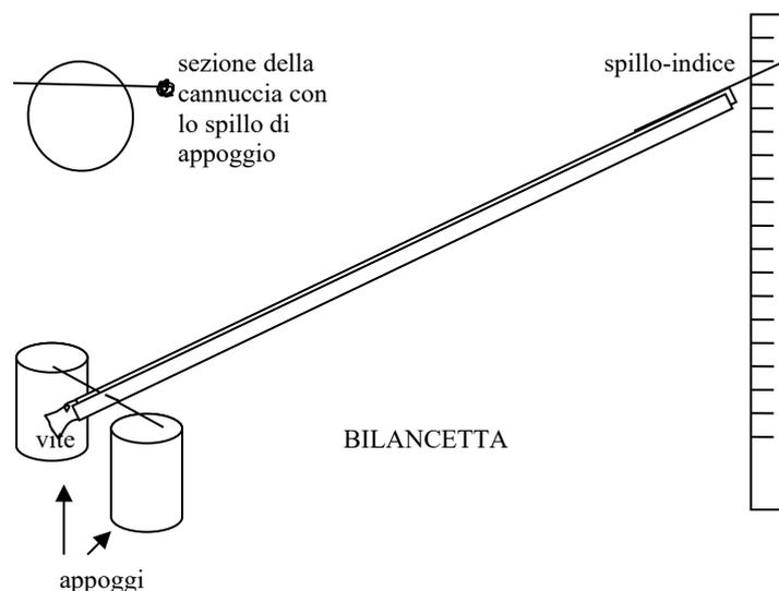
Infila la vite ad un'estremità della cannuccia.
