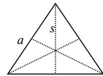
dove  $I$  è il momento di inerzia del triangolo rispetto all'asse di oscillazione,  $m$  è la massa di tutto il profilo (pari a  $3M$  se si indica con  $M$  la massa di un solo lato) e  $s$  la distanza del baricentro dai vertici del triangolo.
