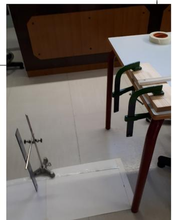
Fissare al tavolo con una o due morse il blocco di legno in maniera che il tratto finale dello scivolo risulti orizzontale. Tenere la pallina sullo scivolo a contatto con l'estremità inferiore del bastoncino di legno, il punto di partenza per la caduta della pallina. La posizione dello scivolo va aggiustata in maniera che la pallina nella posizione di partenza si trovi fra 350 mm e 400 mm di distanza dal piano del banco di lavoro.
