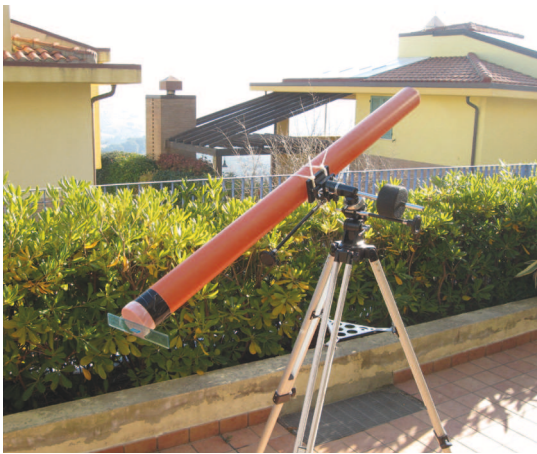
Figura 16. La camera oscura utilizzata per misurare il diametro angolare \beta del Sole, fissata sulla piccola montatura equatoriale EQ1, utile per puntare facilmente il Sole utilizzando i movimenti micrometrici. Si noti l'estremità inferiore chiusa con una plastica semitrasparente alla quale è stato fissato un righello.
