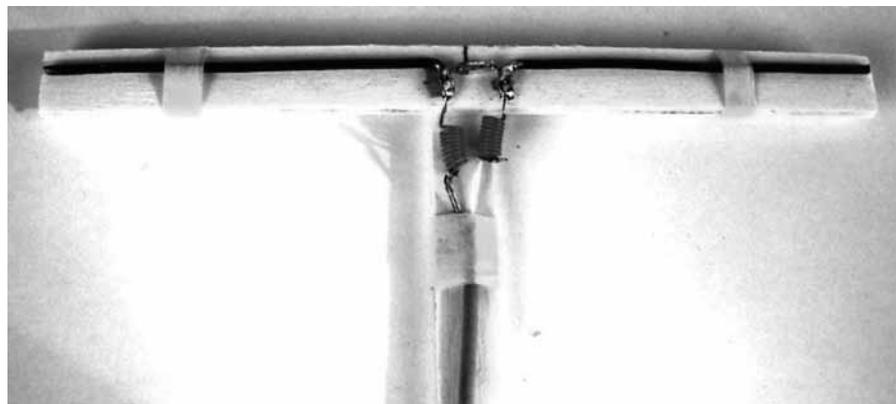
Due pezzi di filo di rame grosso, un diodo al centro, due saldature. Lunghezza 16 cm. Le due spiraline sono due piccole induttanze necessarie per bloccare la radiofrequenza ma non la tensione continua che si manifesta ai capi del diodo.
