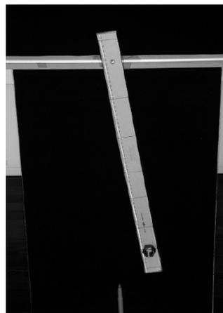
Figura 1. Visione d'insieme dell'apparato sperimentale. La matita posizionata sul pavimento in corrispondenza della verticale passante per il punto di sostegno del pendolo è utile per traguardare con maggior precisione il pendolo, onde scattare il cronometro all'inizio e alla fine di un numero intero di oscillazioni. Le linee tracciate sulla riga servono per collocare i dadi in posizioni ben individuabili.
