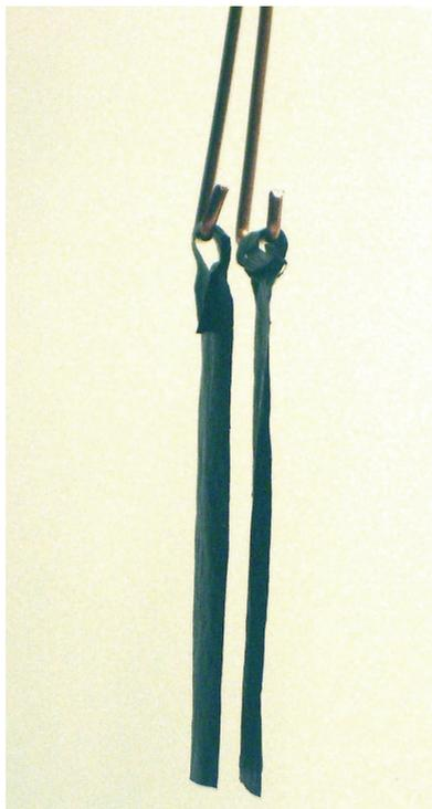
Figura 5. Dettaglio della sospensione delle foglioline. La parte superiore è ripiegata ad anello attorno ad un grosso ago e il lembo incollato. Ogni fogliolina ruota con minimo attrito attorno al supporto di filo di rame ripiegato verso l'alto in modo che esse non sfuggano.
