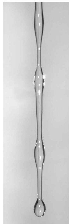
Figura 3. La formazione di una goccia al fondo di un filo d'acqua. Le gocce crescono da rigonfiamenti nel flusso liquido.
