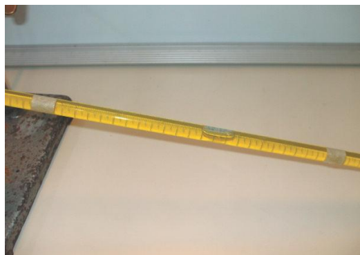
Figura 3. Moto di una bolla d'aria in una buretta con olio.
