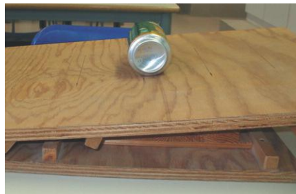
Figura 1. Moto di una lattina parzialmente riempita con maizena-acqua su un piano inclinato.
