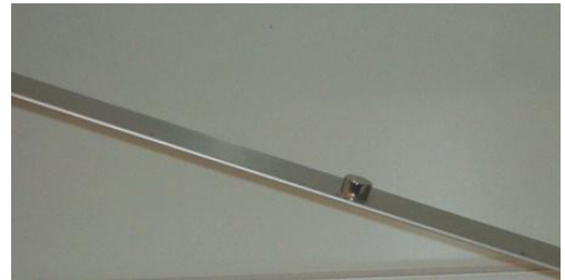
Figura 8. Moto di un magnete su un piano inclinato in alluminio.
