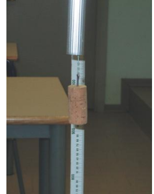
Figura 7. Moto di un supermagnete in un tubo di alluminio.
