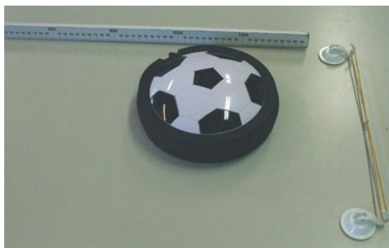
Figura 10. Disco a cuscino d'aria elettrico e sistema ad elastico per mettere in movimento il disco.
