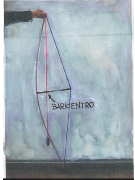
Figura 6. Ricerca del baricentro con l'arco teso (è stata inserita un'asticella che produce un allungamento dell'arco pari a \Delta l ).
